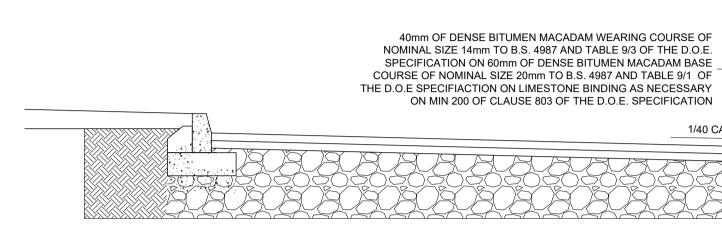
TYPICAL SECTION THROUGH SITE ROAD INFILTRATION TRENCH SCALE 1:25
